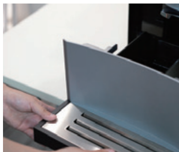
4. เช็ดให้สะอาด ประกอบกับใส่ถาดกับตัวเครื่อง
