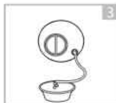
หลังจากระบายน้ำจนหมด ให้ใส่สายท่อระบายน้ำกลับเข้าไป
