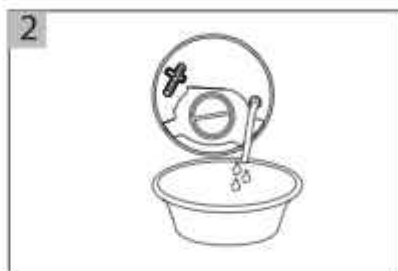
2. ในกรณีที่ไฟฟ้าขัดข้องให้เปิดฝาครอบประตูเพื่อระบายน้ำเย็นออกจากถังชัก
