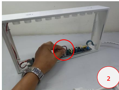
ประกอบคอนเนคเตอร์ต้องแน่น แข็งแรง
