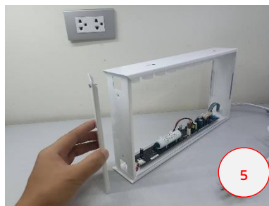
ประกอบคอนเนคเตอร์ต้องแน่น แข็งแรง
