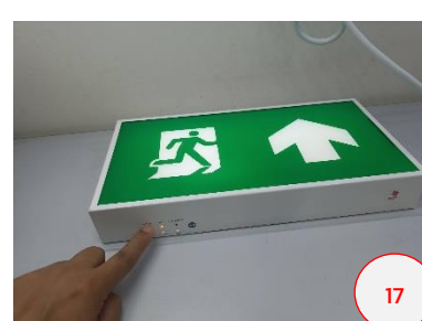
กดสวิทช์ "OFF" ที่ตัวเครื่องเพื่อปิด การทำงานของตัวเครื่อง
