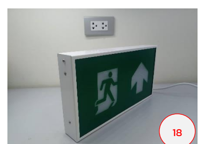
กดสวิทช์ "Test" ที่ตัวเครื่องหรือ รีโมทเพื่อทดสอบการทำงาน เบื้องต้น แสงสว่างของป้ายจะต้อง สว่างอย่างต่อเนื่อง
