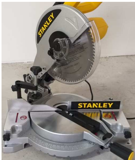
ปรับเครื่องตัดบัวไฟฟ้า ให้มุม 45 องศา
