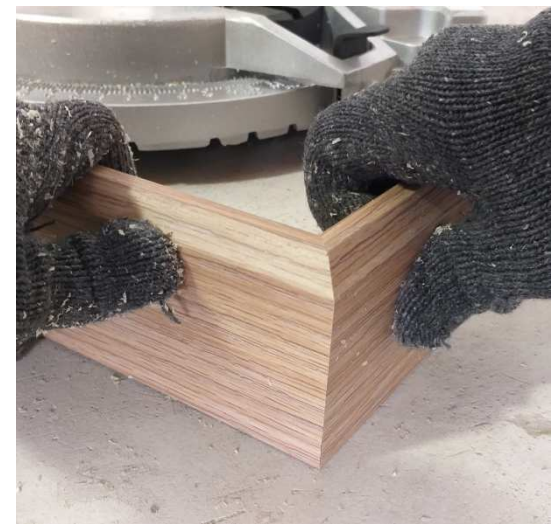
ตัดด้วยเครื่องตัดไฟฟ้า และลองประกอบเข้ามุม
