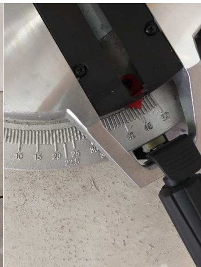
ปรับเครื่องตัดบัวไฟฟ้า ให้มุม 45 องศา
