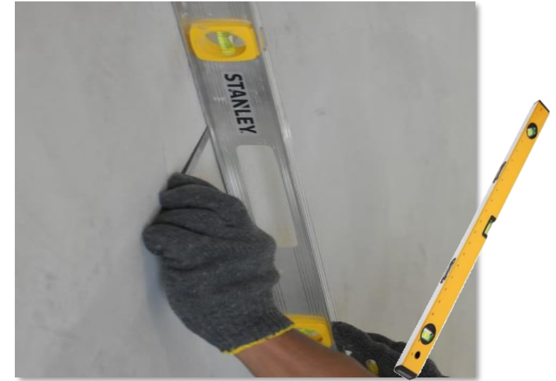
การตรวจสอบความเรียบพื้น และผิวหน้า (ค่า \pm 2 มม. ที่ความยาว 1 ตารางเมตร)
