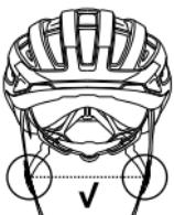
En caso de que la longitud de las correas de los dos lados no sea igual, puede hacer que sea la misma si tira de cualquier lado a través del soporte de la parte trasera del casco.
