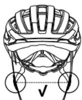
Als de riemen niet aan beide kanten even lang zijn, kunt u ze op gelijke lengte brengen door eraan te trekken (ze lopen via de constructie aan de achterkant van de helm).
