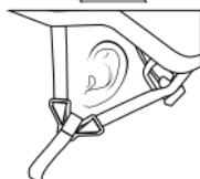
La longueur des sangles doit toujours être égale des deux côtés et les séparateurs de sangle doivent être placés en-dessous et légèrement devant les oreilles.
