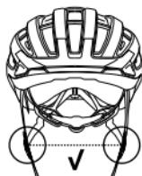
Caso as fitas tenham comprimentos diferentes da cada lado, por favor tenha em conta que as fitas podem ficar com o mesmo comprimento se as puxar para o lado necessário através do suporte na parte de trás do capacete.
