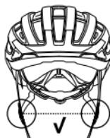
Если с разных сторон ремни получились разной длины, их можно выровнять, потянув в любую сторону через крепление на задней стороне шлема.
