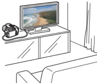
Gunakan kabel HDMI HTC-100 (dijual terpisah) atau kabel AV stereo AVC-DC400ST (dijual terpisah) untuk menghubungkan kamera ke perangkat TV. Kemudian Anda dapat memainkan ulang film dan foto yang direkam pada perangkat TV.
