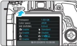
Jika Anda menekan tombol <INFO.> saat kamera siap untuk memotret, layar untuk **[Displays camera settings (Tampilan pengaturan kamera)]**, **[Electronic level (Level elektronik)]** (hal.70), dan **[Displays shooting function (Tampilkan fungsi pemotretan)]** (hal.378) akan ditampilkan secara berurutan.
