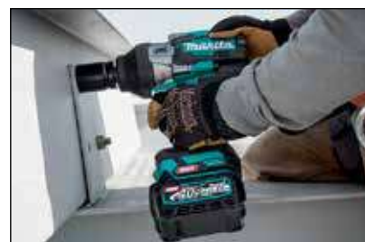
Motor buatan Makita menghasilkan torsi maksimal 1.800 N-m.
