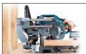
Desain rel ke depan memungkinkan alat ditempatkan sejajar dengan dinding
